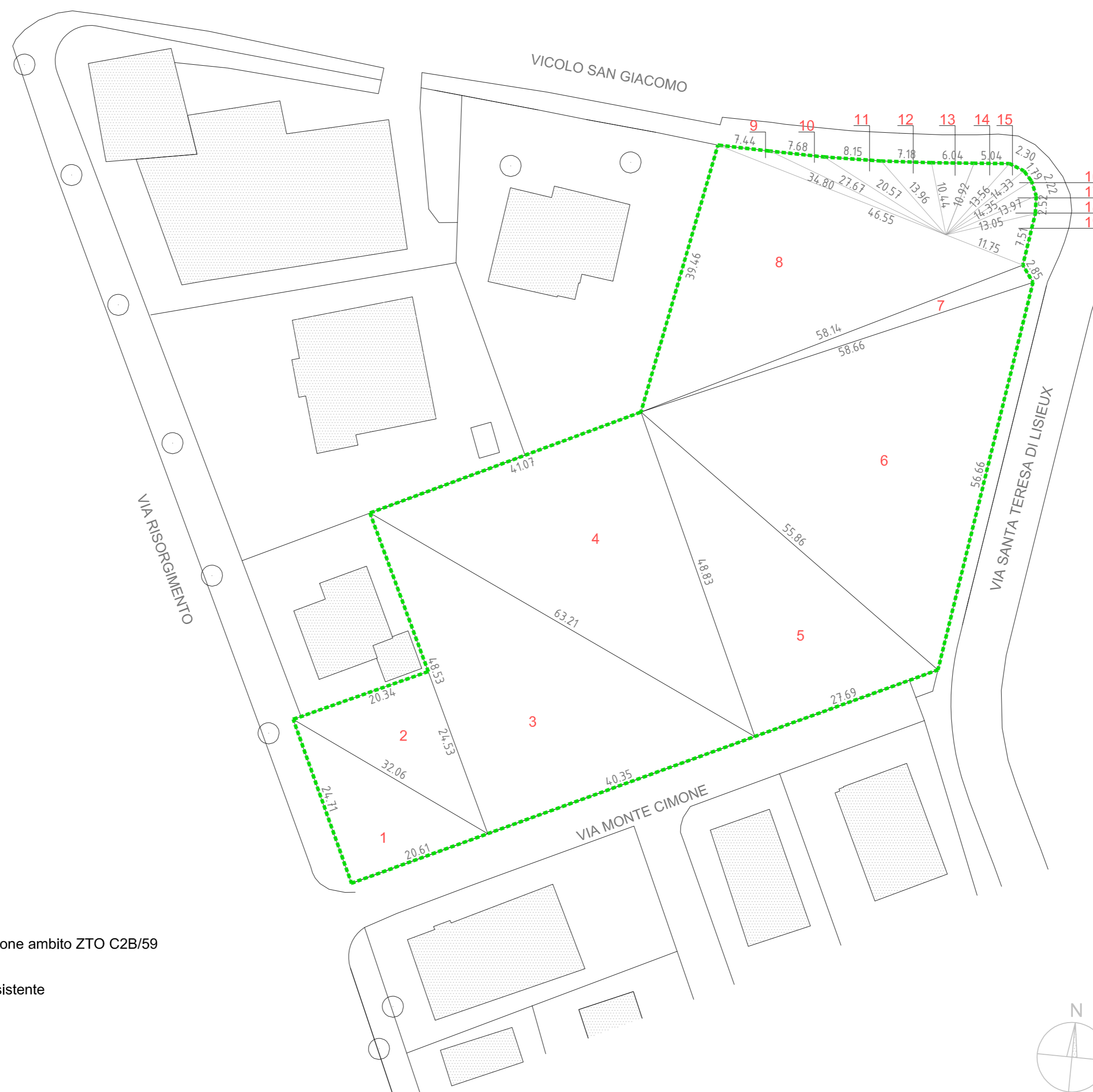
SOVRAPPOSIZIONE AMBITO P.R.G./RILIEVO - CALCOLO DELLE SUPERFICI - scala 1:500
